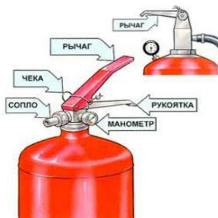
Приведение в действие порошкового огнетушителя
